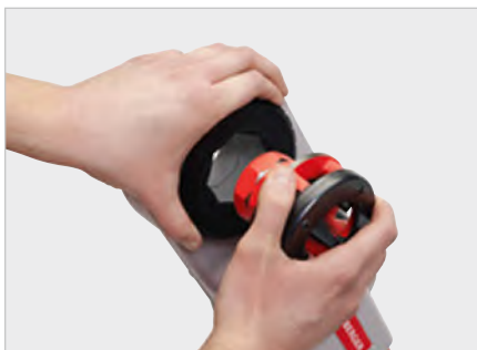
Werkzeuglose Speed-Lock Schneidkopfaufnahme
