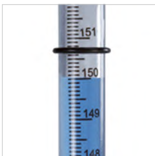
Prüfskala bis 155 mbar auf transparentem Verlängerungssteckrohr
