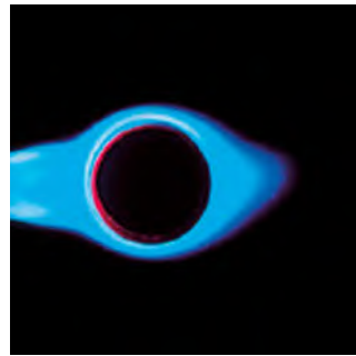
Hohe Flammentemperatur durch Zyklonverwirbelung
