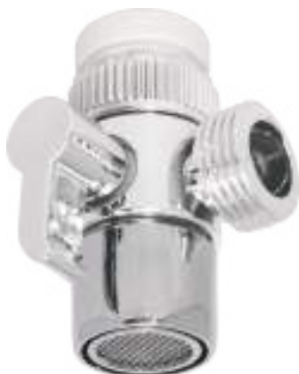
Deviatore a cartuccia in plastica per aeratore M24/F22 con uscita 1/2"
