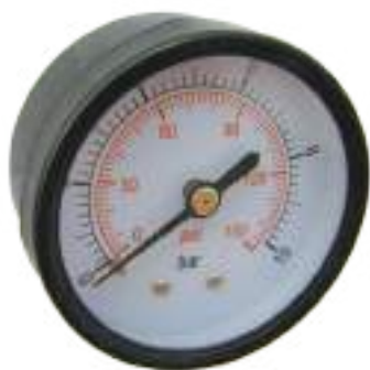
Manometro 1/4" cassa metallo/vetro Ø55 10 bar attacco assiale (posteriore)
