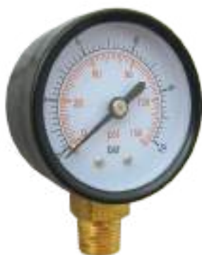
Manometro 1/4" cassa metallo/vetro Ø55 10 bar attacco radiale (verticale)
