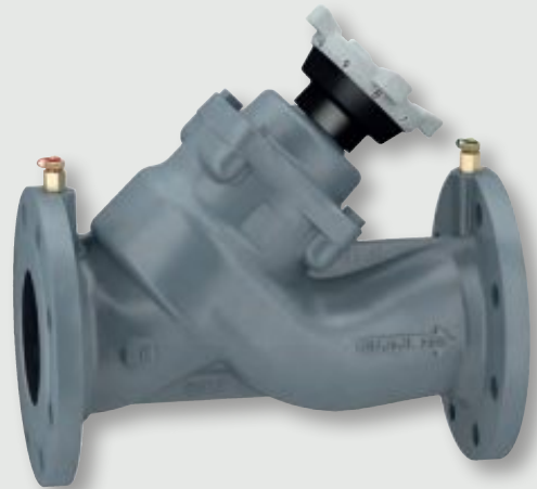
Valvola di bilanciamento (detta anche ad orifizio costante) con misura indiretta delle portate e con attacchi piezometrici a monte dell'otturatore
