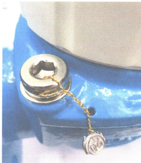
Рисунок 4 – Пломбування змінної вимірювальної вставки
