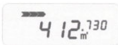
Рисунок 2 — Загальний вид електронного показувального пристрою лічильника
