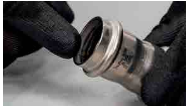
Рисунок 22 - Перевірка ущільнювального кільця
