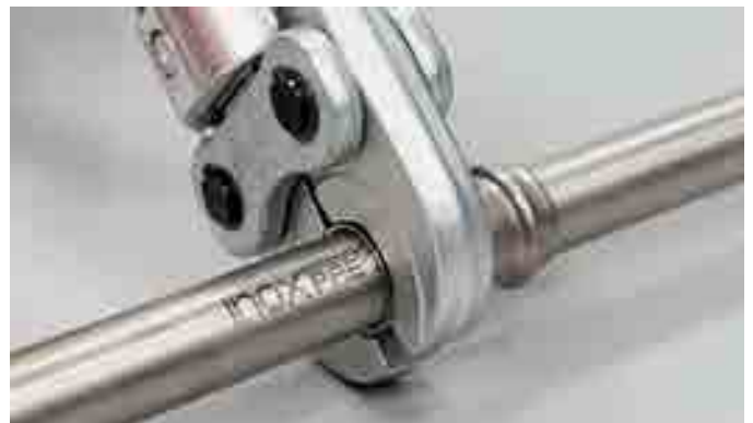
Рисунок 25 - Виконання з'єднання преса
