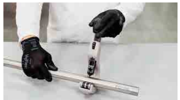
Рисунок 19 - Відрізання труби за довжиною
