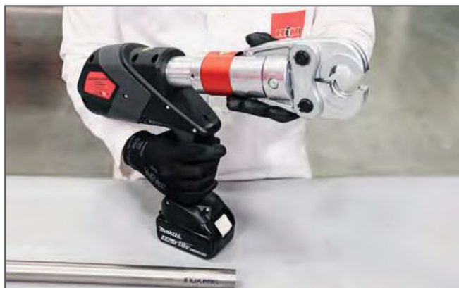
Preparazione della macchina pressatrice / Press machine preparation
